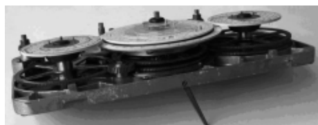
Fig. 7 - Spaccato della calcolatrice Arici 68
